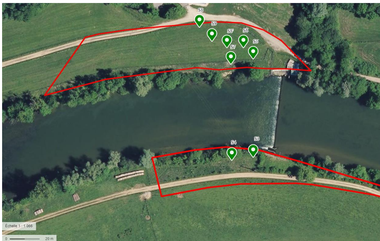
Figure 28 : Localisation des sondages réalisés
