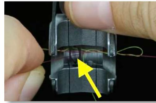
Passez le morceau de fil de 3 cm de gauche au travers de l'ouverture de la languette de gauche (**par dessous les 2 fils**).
