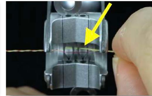
Passez le morceau de fil de 3 cm de droite au travers de l'ouverture de la languette de droite (**par dessus les 2 fils**).
