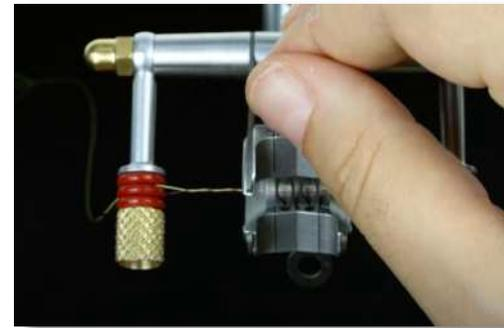
Faites tourner l'ensemble rotatif ( 4 à 6 tours complets en fonction des  $\varnothing$  ).
