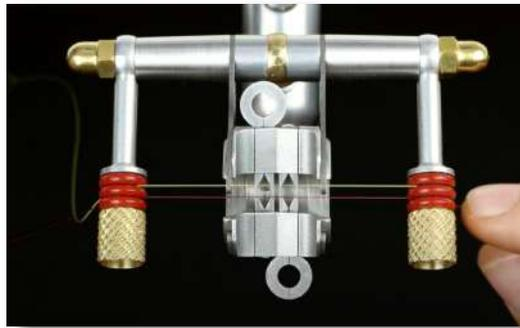
Coincez le second morceau de fil en le passant **sur** les languettes métalliques et en le laissant dépasser de 3 cm à gauche.
